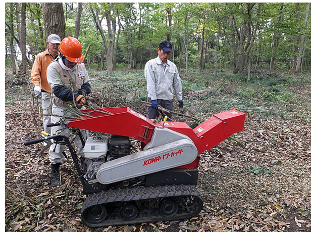
破碎機による間伐材の処理
